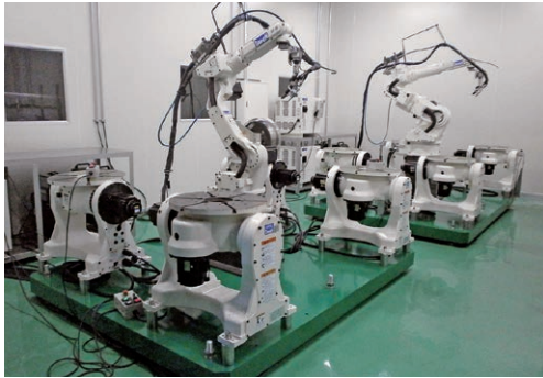
▲TIG 溶接ロボット+ポジション(ロボット1台につき各4台)
