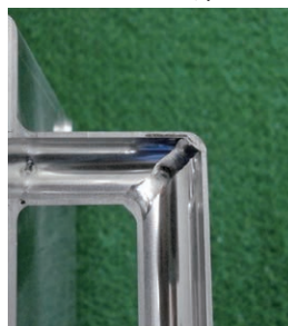
▲パイプ裏波溶接 (SUS)
