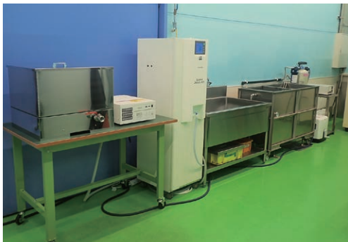
▲超音波洗浄機・超純水発生装置
