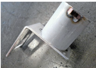
▲ファイバーレーザー溶接前 (SUS)
