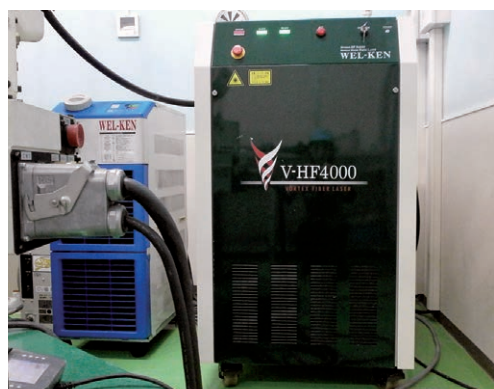
▲ファイバーレーザー溶接機
