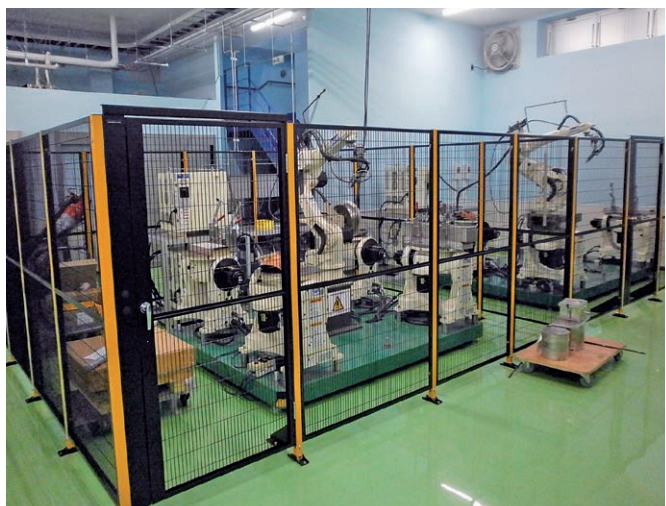
TIGロボット溶接
