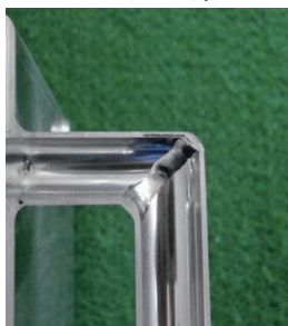
▲パイプ裏波溶接 (SUS)
