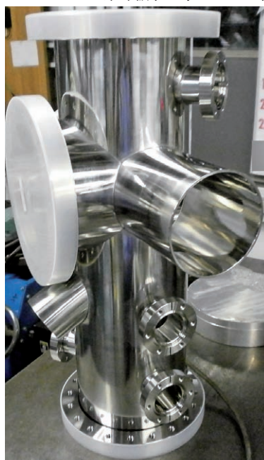
▲ICF配管 (SUS)
