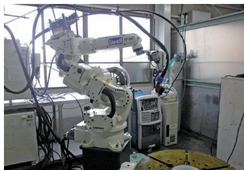
▲プラズマ溶接ロボット
