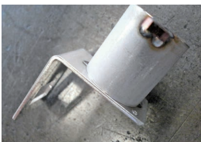
▲ファイバーレーザー溶接前 (SUS)
